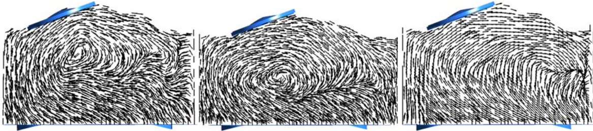
Figura 5.12. Patrón de velocidad sobre planos paralelos al plano medio del cilindro (270 CA). Izquierda: plano medio de la válvula izquierda. Centro: plano medio del cilindro. Derecha: plano medio de la válvula derecha.
