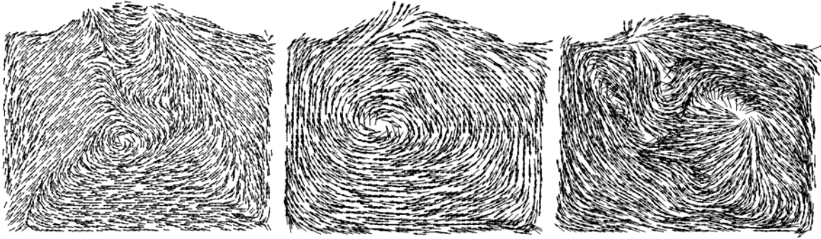
Figura 5.40. Campo de velocidad sobre el plano medio del cilindro al final de la etapa de admisión para las tres velocidades de motor.
