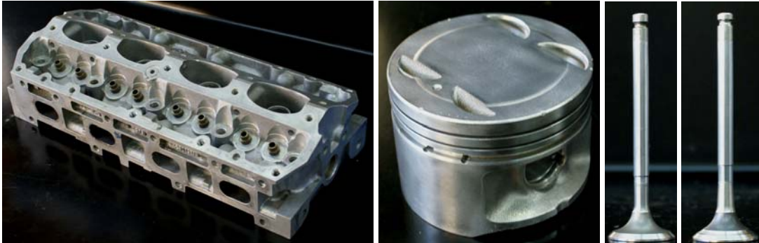
Figura 3.3. De izquierda a derecha: tapa de cilindros, pistón, válvula de admisión y válvula de escape del motor Fiat Torque.
