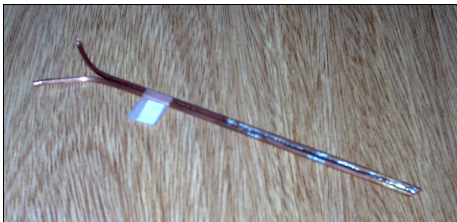
Figura 4-11: Construcción del modelo. Vista de una pata con dos conductos.
