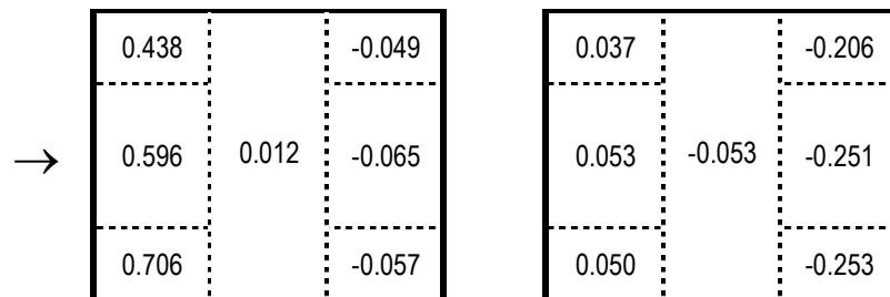
Figura 8-23: Coeficientes de presión c_{p_{tot,m\acute{a}x}} y c_{p_{tot,m\acute{i}n}} para modelo S3, viento a 90° desde la izquierda.
