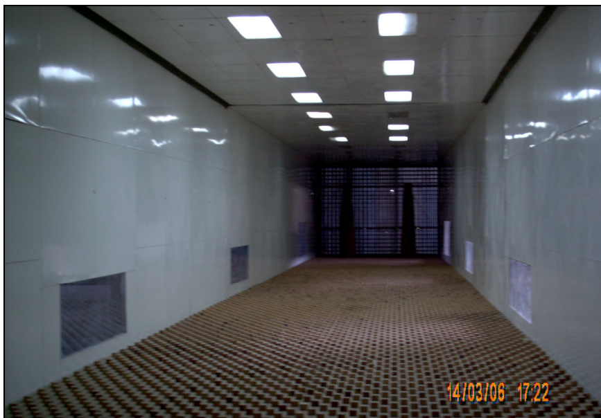
Figura 4-7: Dispositivos para reproducción de la capa límite en la cámara de ensayos.
