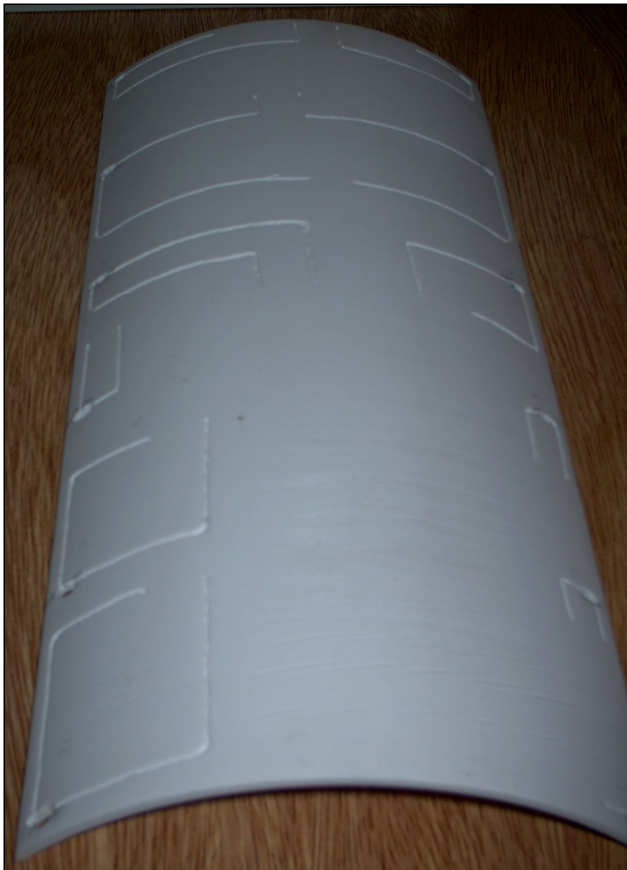
Figura 4-10: Construcción del modelo. Fresado de conductos y perforación orificios para toma de presión y fijación de patas.
