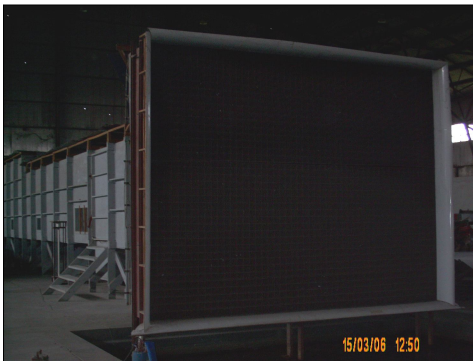
Figura 4-5: Túnel de viento de la UNNE. Vista del convergente.
