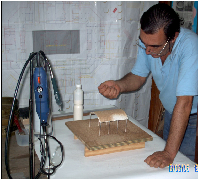
Figura 4-13: Construcción del modelo. Colocación de la arena en el extradós.
