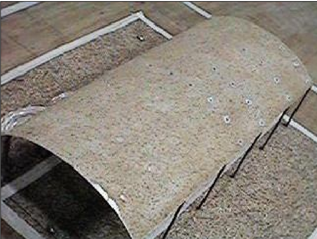
Figura 4-3: Vista de un modelo, con rugosidad superficial y tubos de toma de presión (Natalini, 2001).
