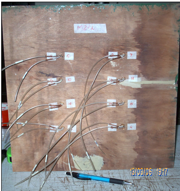
Figura 4-14: Construcción del modelo. Mangueras de conexión bajo el piso de la cámara de ensayos.
