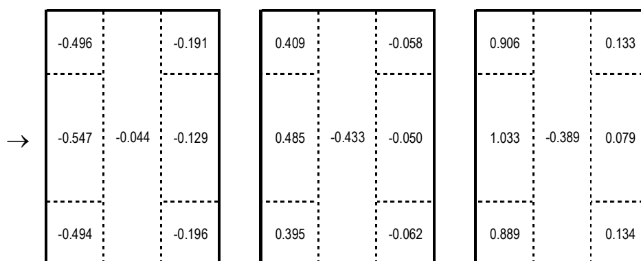
Figura 6-13: Modelo M2, coeficientes de presión medios c_{pi} , c_{pe} , c_{pt} obtenidos en túnel de viento. Viento desde la izquierda.
