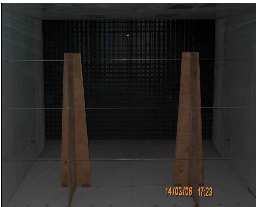
Figura 4-8: Detalle de Figura 4-7, sección de entrada, honeycomb y spires , para regularización del flujo y generación de vórtices.
