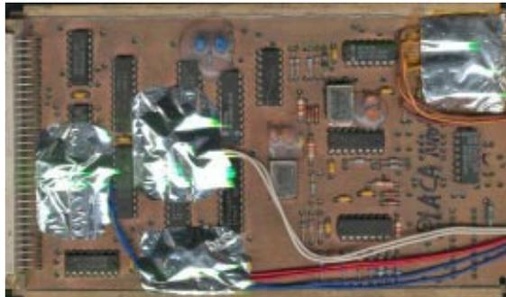
Fig. 5 – Disposición de calefactores y sensores de temperaturas en la plaqueta de ensayos
