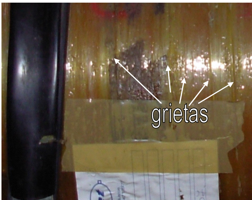
Figura 2: Grietas observadas en cilindros de GNC Tipo 2, en condiciones normales
