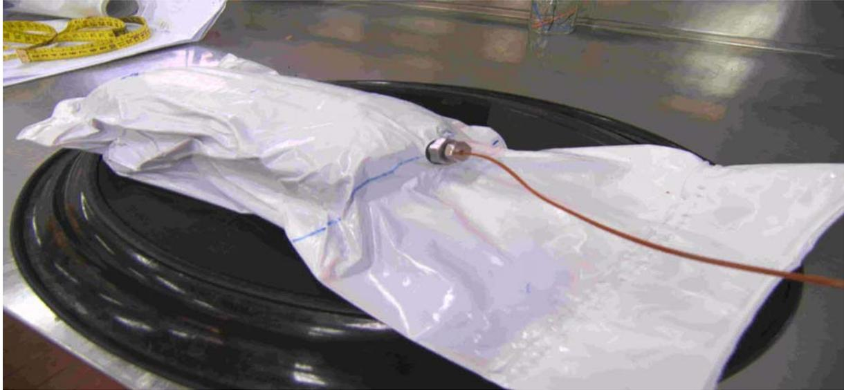
Figura 1: Músculo insertado con Termocupla Axial.
