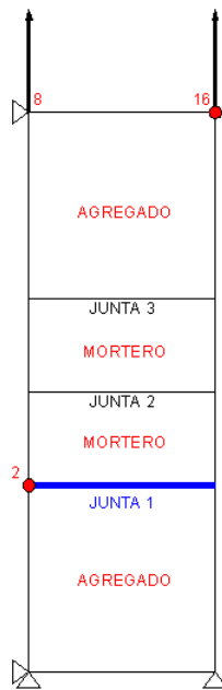
Figura 2: Malla, esquema de carga y condiciones de borde. Agregado y mortero elásticos, juntas agregado – mortero viscoplásticas, junta central mortero – mortero elastoplástica.
