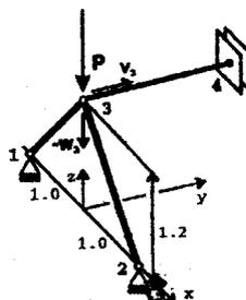
Figura 1: Estructura de tres barras articuladas: descripción geométrica
