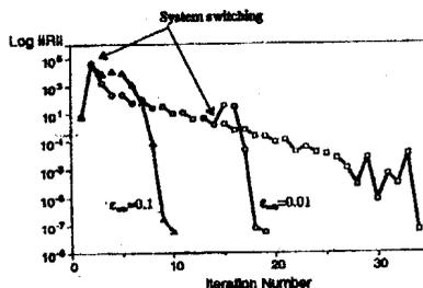
Figura 6: Pórtico plano : evolución de la norma del residuo en el punto de bifurcación D
