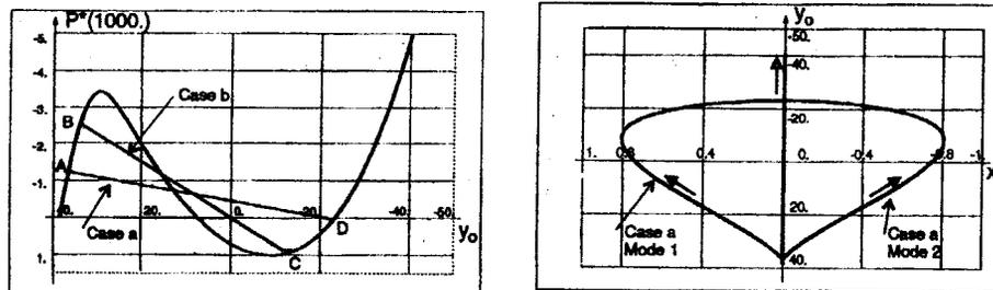
Figura 5: Pórtico plano. Izquierda: curva carga vs. desplazamiento vertical en el punto *O*; derecha: curva desplazamientos horizontal vs. vertical en el punto *O*.
