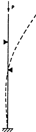
Figura 2: Columna empotrada-libre con dos restricciones de contacto.
