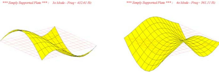
Figure 4 – Vibration shapes (a) 3<sup>o</sup> Mode (b) 4<sup>o</sup> Mode.
