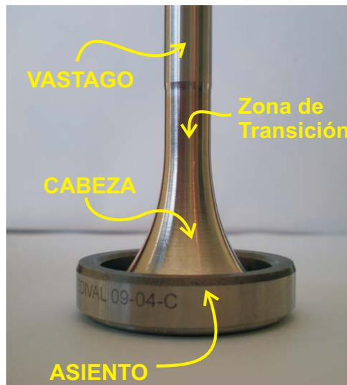
Figura 2: Denominación de las partes de una válvula de motor de combustión interna y el asiento.
