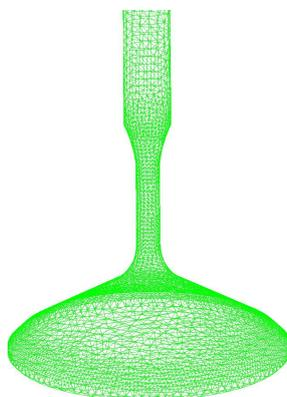
Figura 13: Topología de la malla un modelos tridimensional de válvula.
