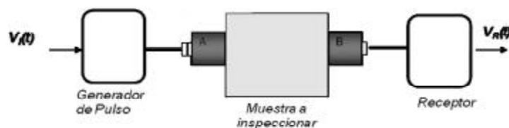
Figura 3: Esquema de medición
