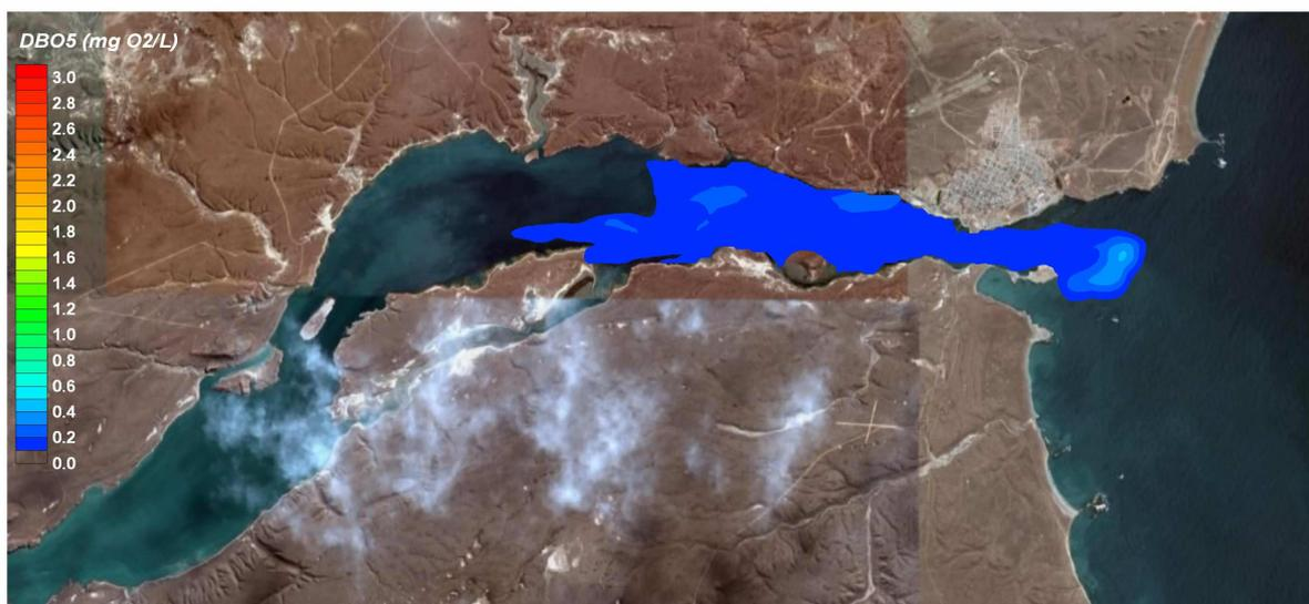
Figura 10. Campo de concentración de DBO<sub>5</sub> para planta de pre-tratamiento y emisario unificados. Hora 19.
