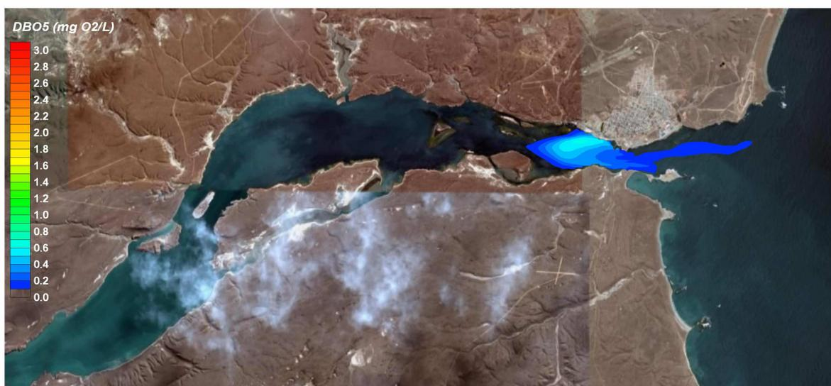
Figura 8. Campo de concentración de DBO<sub>5</sub> para planta de pre-tratamiento y emisario unificados. Hora 13.
