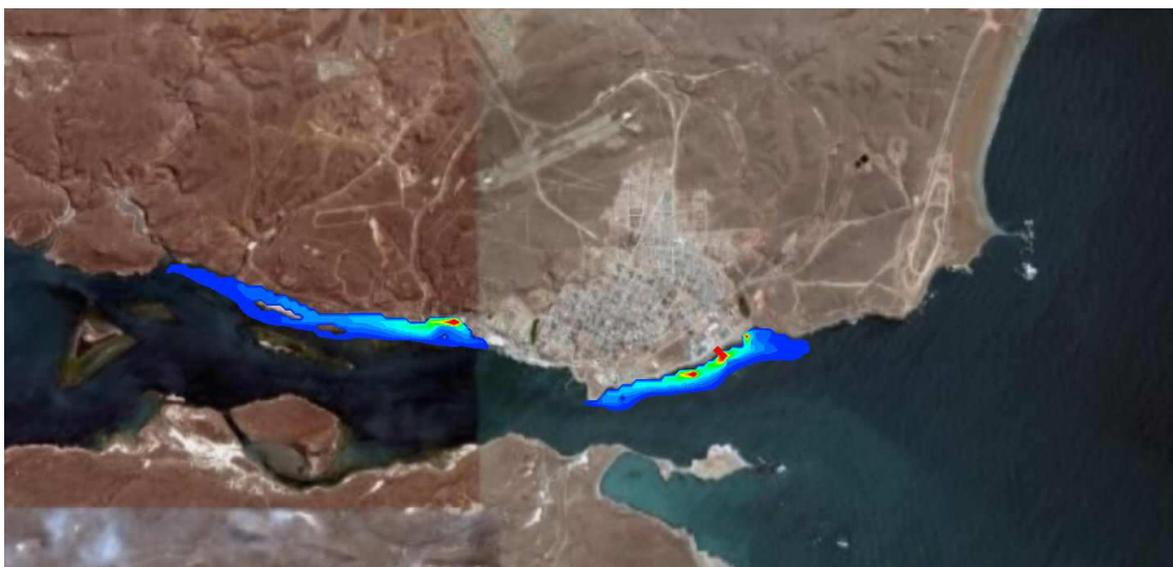
Figura 6. Campo de concentración máxima de  $DBO_5$  para una simulación de 30 días. Sectores en rojos y amarillos superando los niveles guía.
