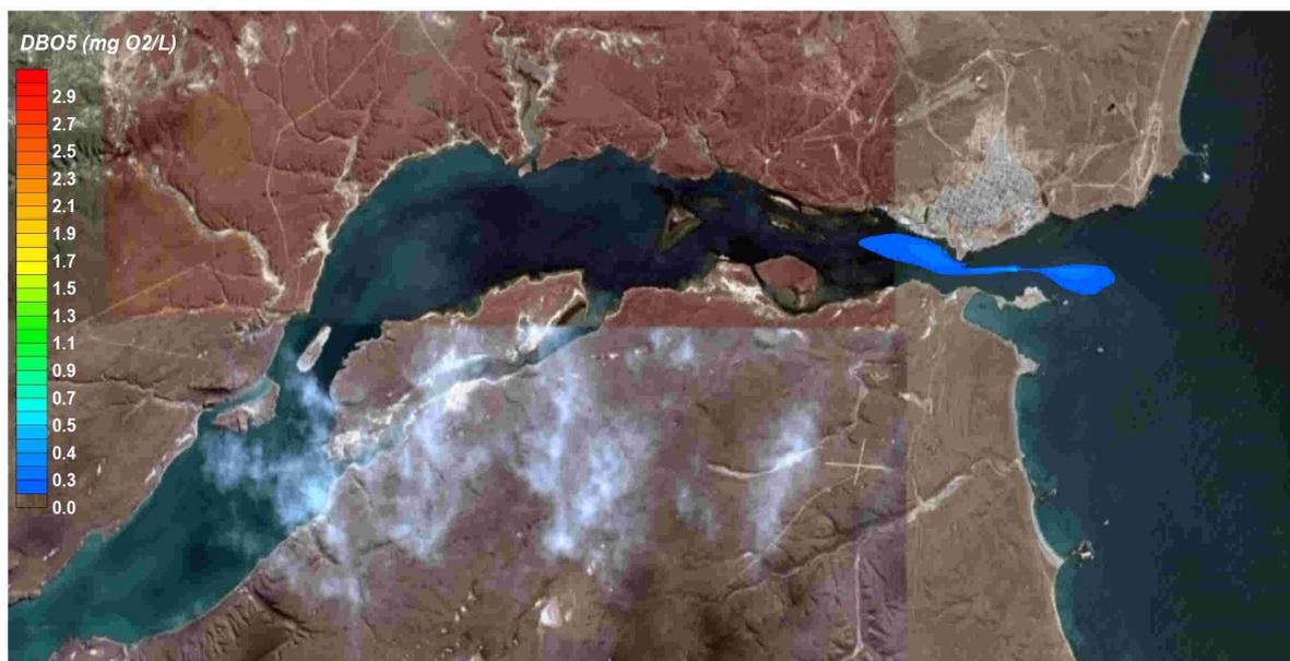
Figura 14. Campo de concentración superficial máxima de DBO<sub>5</sub> para planta de tratamiento físico-químico y emisario unificados.
