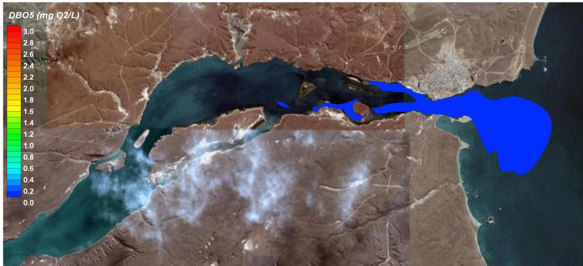
Figura 11. Campo de concentración de  $DBO_5$  para planta de pre-tratamiento y emisario unificados. Hora 22.
