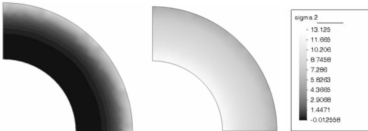
Figura 13. Probetas anulares de hormigón: mapa de tensiones de tracción a los 3 días (izq.) y a los 120 días (der.)
