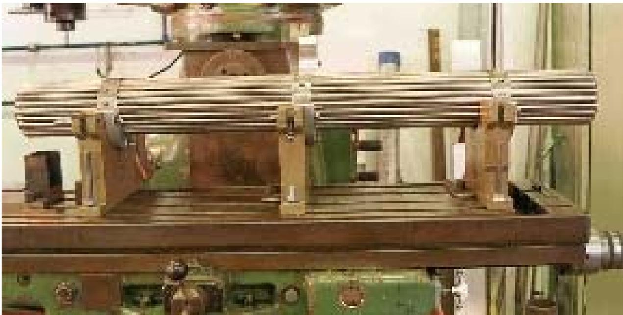
Figura 1: Primer prototipo de combustible CARA.
