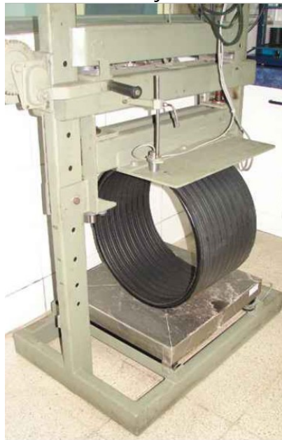
Figura 1: Ensayo de tubería industrial de 300mm de diámetro 1
