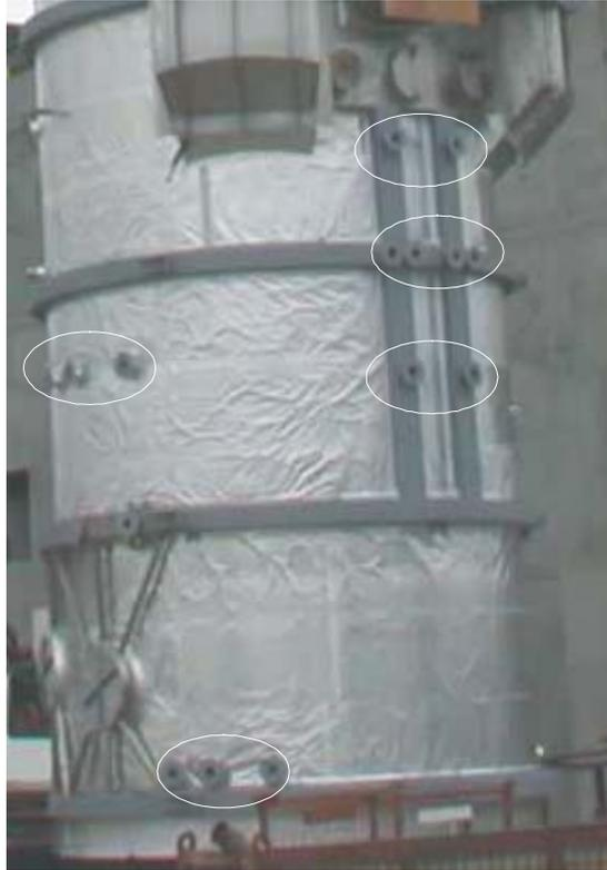
Figura 20: Soportes por detrás de la pared de pileta
