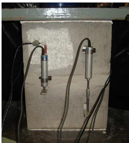
Figura 5 – Prisma de alvenaria instrumentado em ensaio de compressão axial
