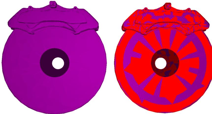
Figura 1 (izq.) malla original de un dispositivo de freno (der.) Elementos seleccionados (y sus vecinos) a mejorar
