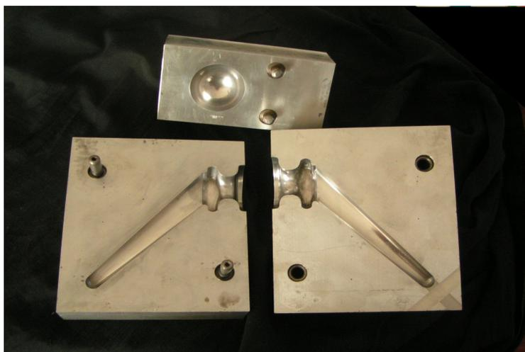
Figura 2: Moldes utilizados para la construcción de los espaciadores de PMMA.
