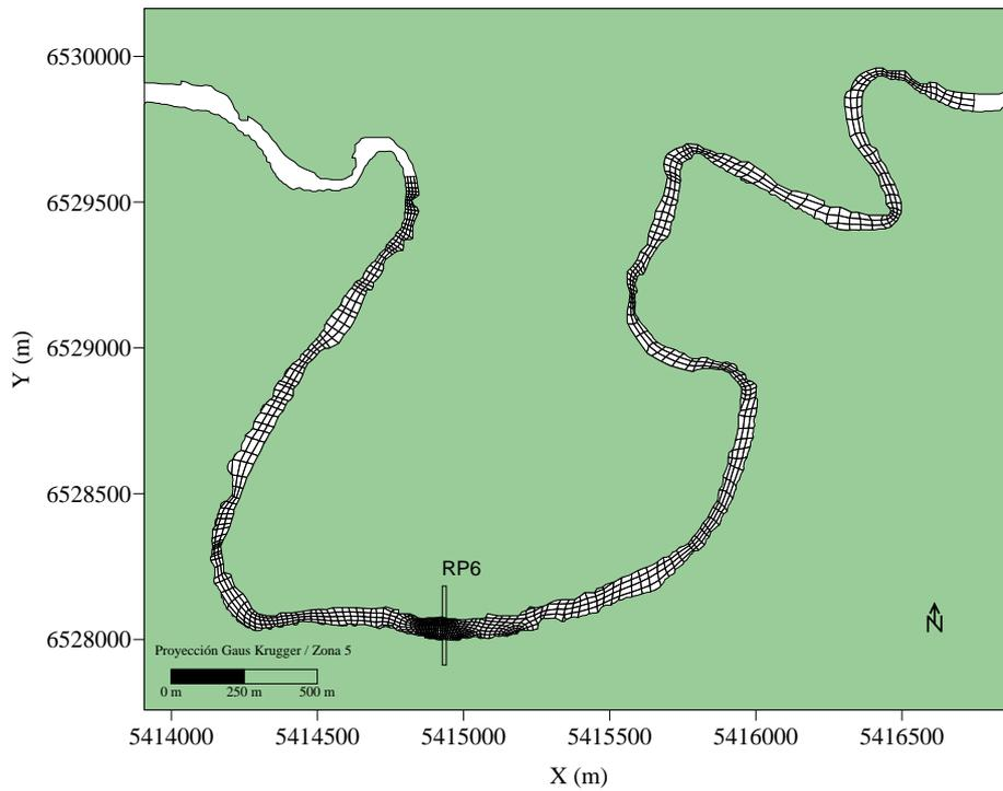
Figura 2: Grilla del dominio “anidado” para el modelo hidrodinámico SisBaHiA<sup>®</sup>, se indica la traza de la sección transversal RP6.
