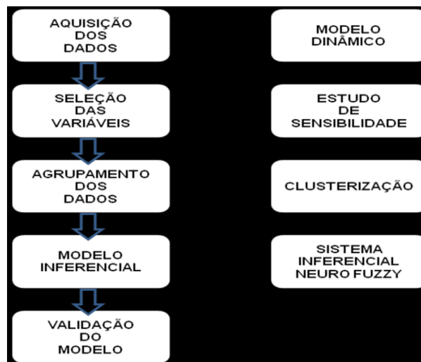
Figura 1: Metodologia Empregada na construção do Soft Sensor.
