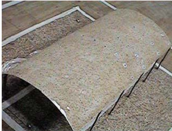
Figura 2: Vista de uno de los modelos de referencia, con rugosidad superficial.
