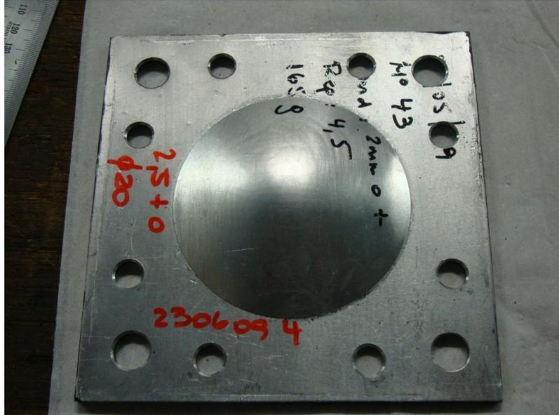
Figura 7: Deformación del punto medio de la placa
