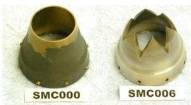
Figura 1: Geometrias escolhidas para simulação. (Bridges e Brown, 2004)
