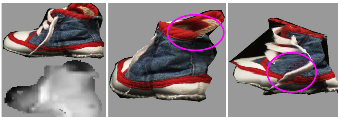
Figura 5: Mapa de disparidades suavizado y vistas del modelo reconstruido. Se señalan los errores producidos por la discontinuidad de superficies y la gran diferencia de disparidades.
