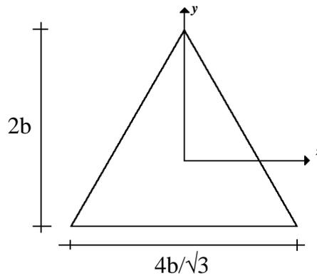
Figura 2. Conducto triangular equilátero.
