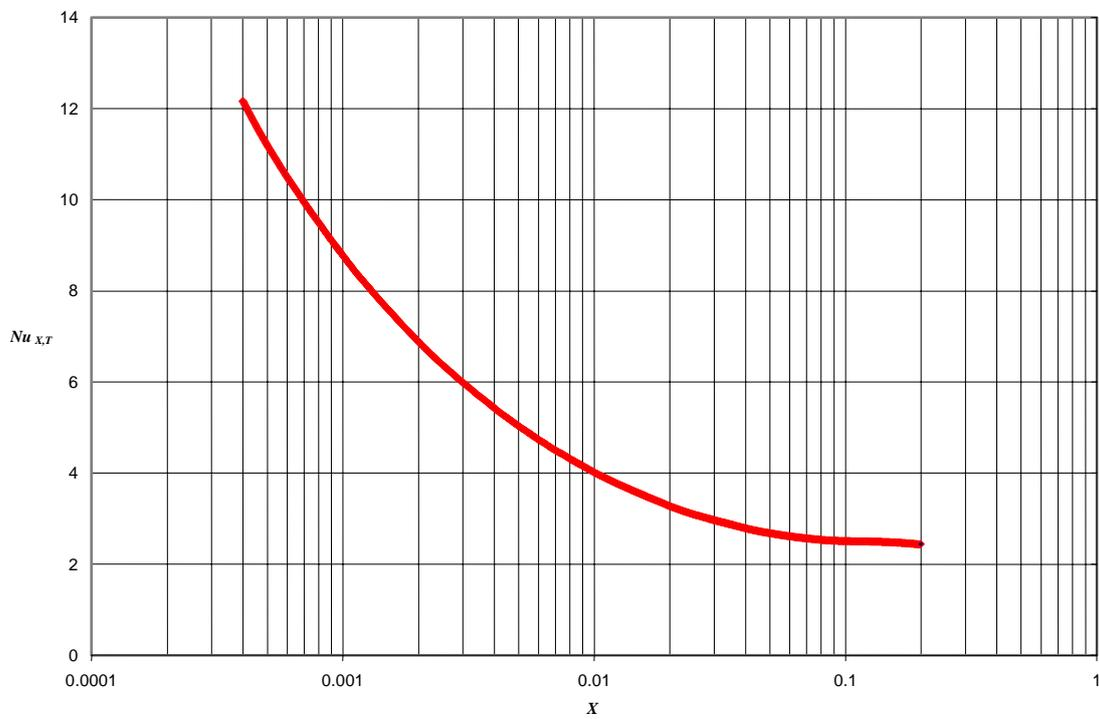
Figura 6. Valores de  $Nu$  a lo largo de la tubería.
