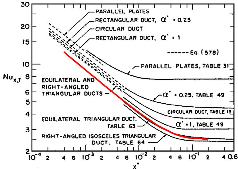
Figura 7. Comparación de la curva obtenida con curvas de referencia.
