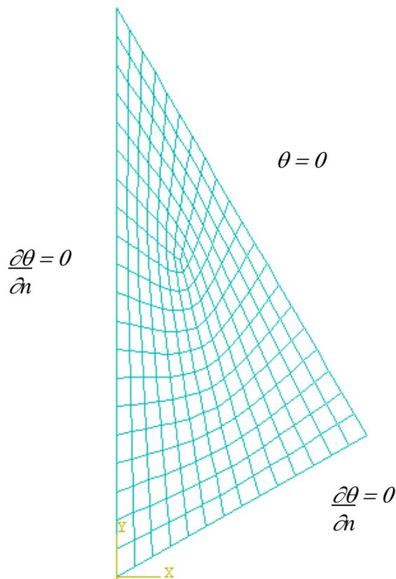
Figura 4. Discretización y condiciones de contorno.
