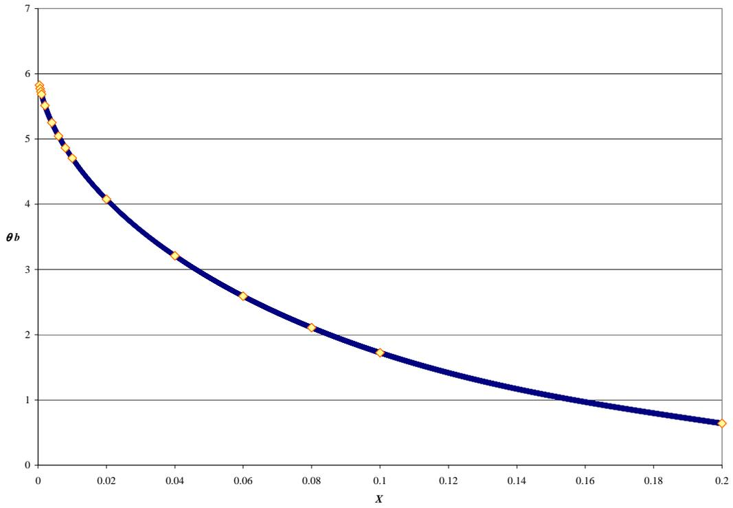
Figura 5. Gráfico de la temperatura adimensional promedio a lo largo de la tubería.
