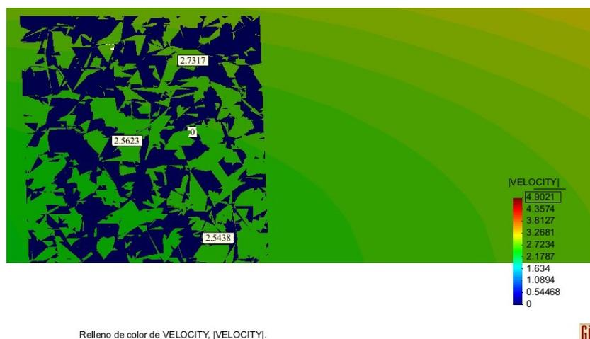
Figura 2. Velocidades dentro del medio poroso (punto  $v = 0$  corresponde al bloque)
