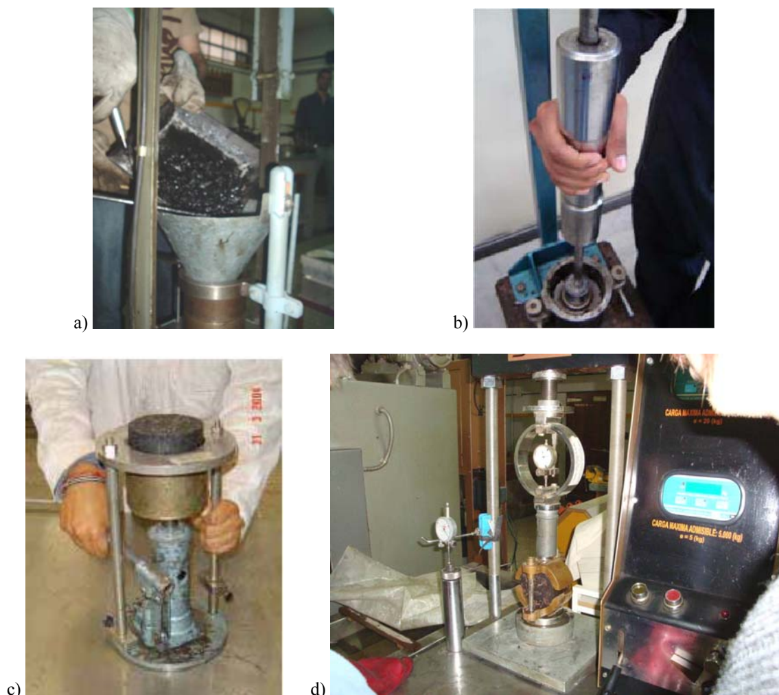
Figura 4: Ensayo Marshall. Imágenes del procedimiento, elaboración y aplicación de carga. a) Colocación de la mezcla, b) Compactación, c) Extracción de la probeta, d) Aplicación de la carga y medición de deformaciones.
