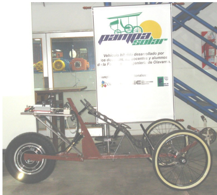
Figura 9. Versión final del chasis
