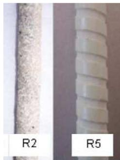
Figura 5: Superfície das barras de fibra de vidro analisadas.
