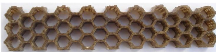
Figura 5: Núcleo honeycomb de compuesto yute-viniléster
