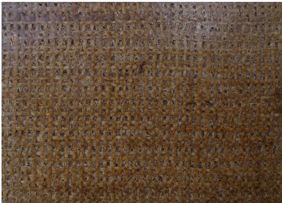
Figura 3: Fotografía de la estructura de la lámina de material compuesto yute-viniléster
