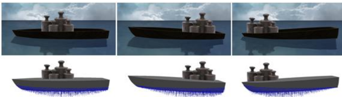
Figura 10. Distribución de peso. Se muestra la presión que ejerce el fluido sobre el bote.
