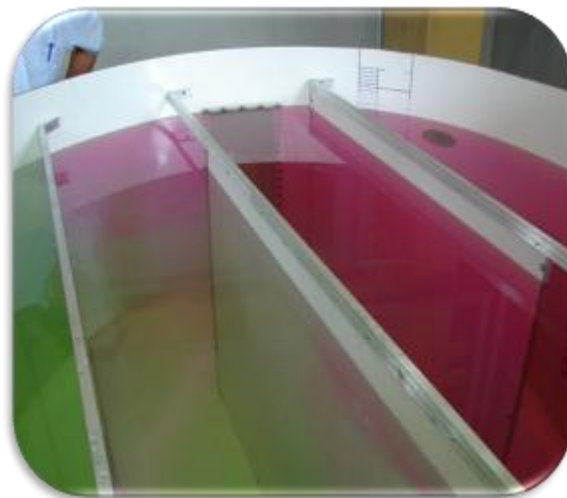
Figura 29. Visualización del comportamiento del flujo en tanque experimental con baffles.
