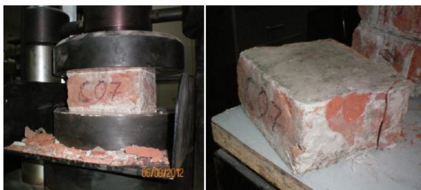
Figura 1: Ensayo a compresión de probetas de mampostería
