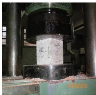
Figura 2: Ensayo a compresión en probetas de mortero.
