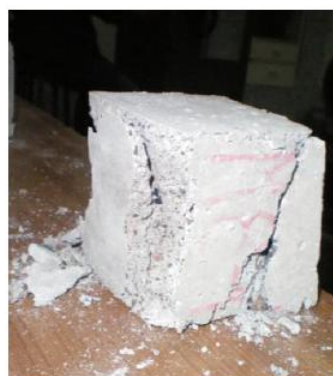
Figura 2: Ensayo a compresión en probetas de mortero.
