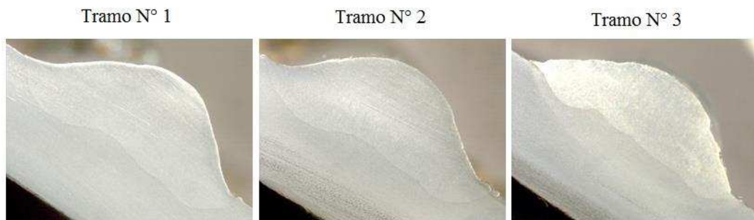
Figura 3 – Fotografía de ensayo N° 2 correspondiente al área de la probeta, donde se aprecia la baja penetración en el tramo N° 3 en el cordón de soldadura.
