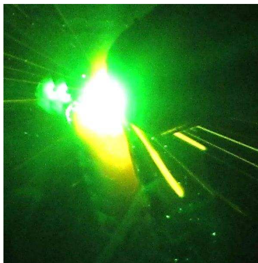
Figura 7 – Fotografía correspondiente al ensayo N°1 de penetración, donde se aprecia el escurrimiento del metal de aporte en el tercer tramo de la probeta.
