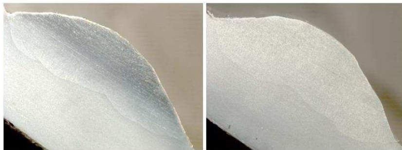
Figura 12 – Fotografías correspondientes al primer tramo del ensayo N° 25 y N° 26 de la matriz de diseño, los cuales se realizaron con un caudal de gas protector equivalente a 16 y 20 [Lts/min] respectivamente, donde se observa que no existen grandes variaciones en la penetración del cordón de soldadura.
