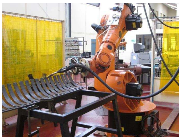
Figura 1. Montaje de probetas curvas para la realización de cordones de soldadura.
