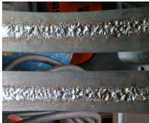
Figura 5 – Efecto que produce una velocidad de soldadura muy alta en la realización de los cordones, donde se aprecia la falta de depositación de material de aporte.
