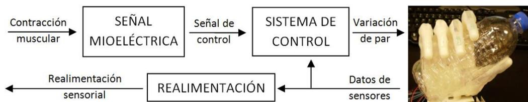
Figura 1. Estructura requerida para obtener un control intuitivo en las prótesis de miembro superior.
