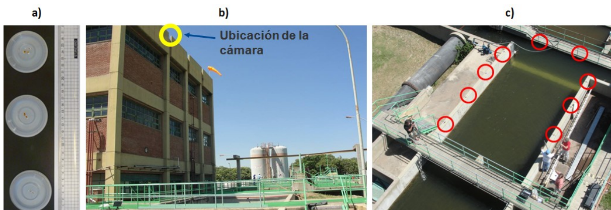
Figura 5: a) Partículas trazadoras adoptados en este estudio; b) Ubicación de la Cámara digital en la implementación de la técnica PTV en la campaña 5; c) Marcas de referencia utilizadas en el proceso de rectificación.
