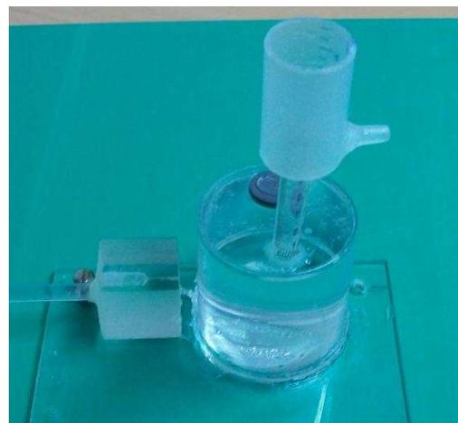
Figura 6: Setup para la medición de la variación de la presión en tiempo.
