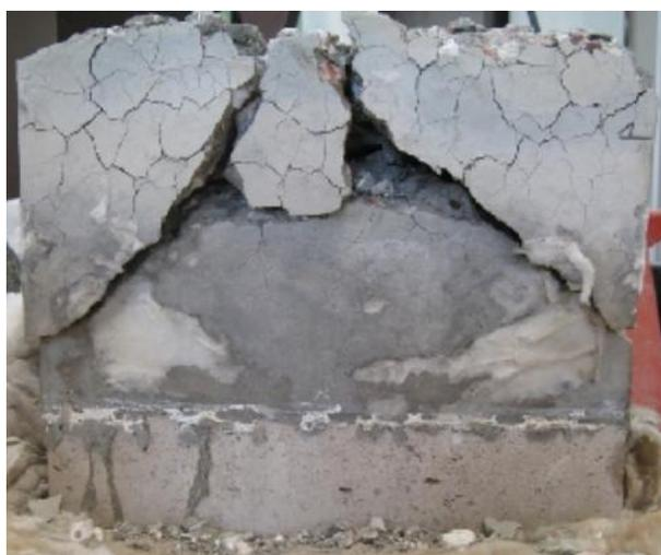
Figura 1: Deterioração de um corpo-de-prova por “spalling” (Ferreira, 2011)
