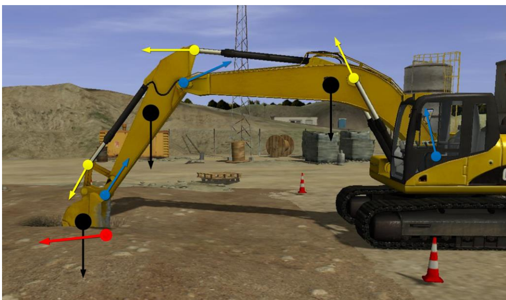
Figura 3: Fuerzas actuando sobre las partes que conforman el brazo de la excavadora
