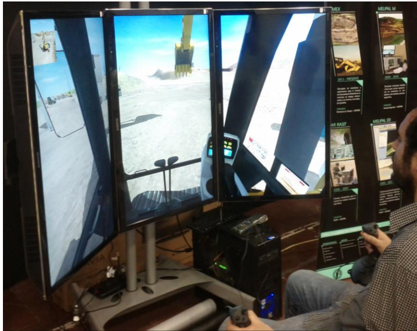
Figura 1: Imagen de montaje con los tres monitores y los joysticks
