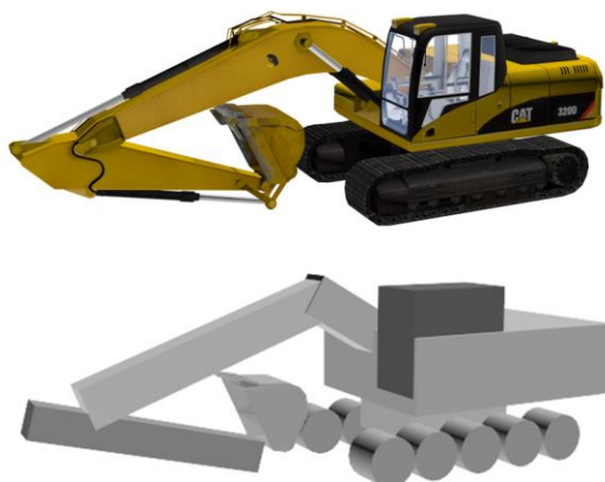
Figura 2: Malla 3D para la visual (Arriba) y primitivas de colisión del motor físico (Abajo)
