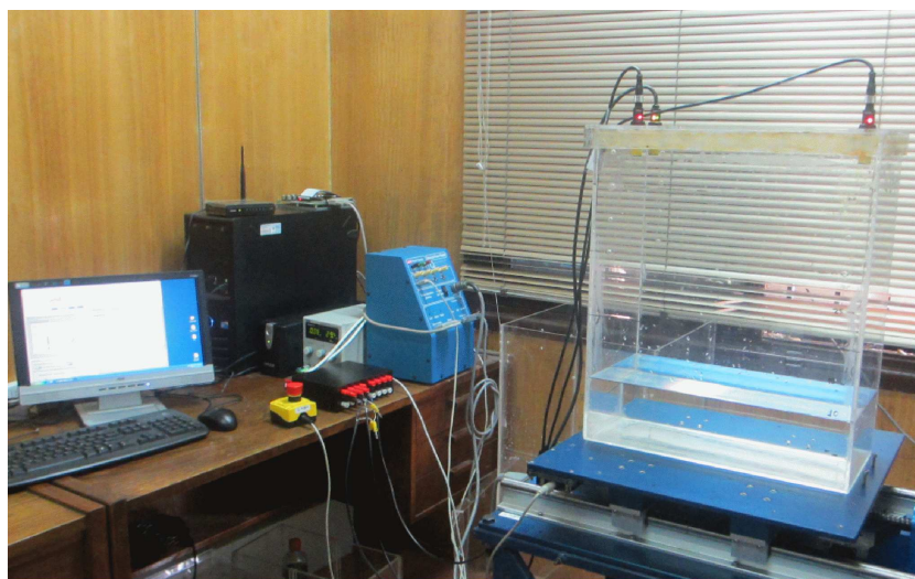
Figura 2: Mesa vibratoria y tanque instrumentado, con equipamiento instalado.
