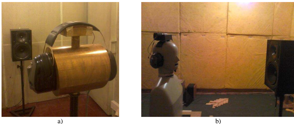
Figura 2. Dispositivos de captura para el análisis del Pseudófono: a) Dispositivo de ensayo acústico normalizado; b) simulador de torso y cabeza.
