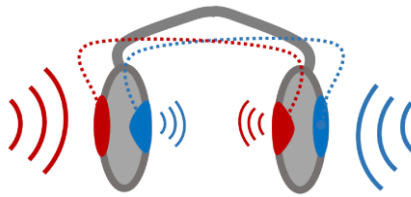
Figura 1. Diagrama de un Pseudófono recibiendo e invirtiendo las claves binaurales de audición.
