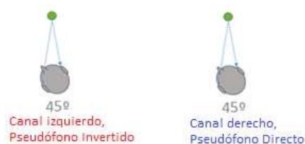
Figura 8: Esquema de medición para validación de correcta inversión.
