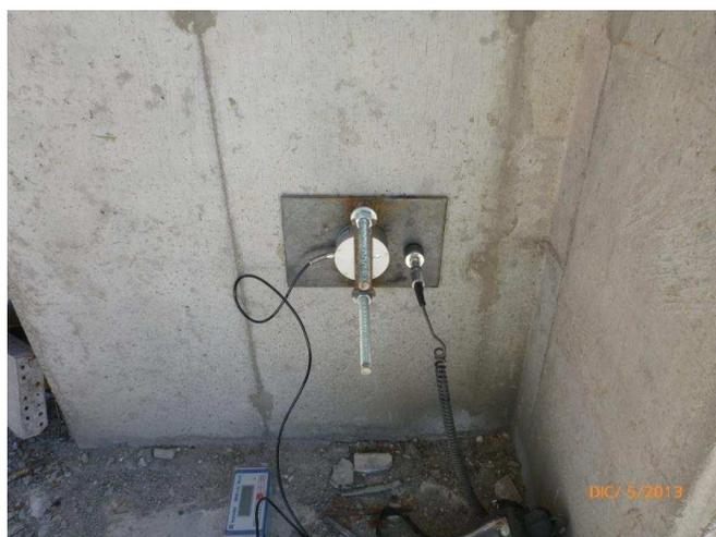
Figura 19: Mediciones experimentales de las vibraciones en la estructura.
