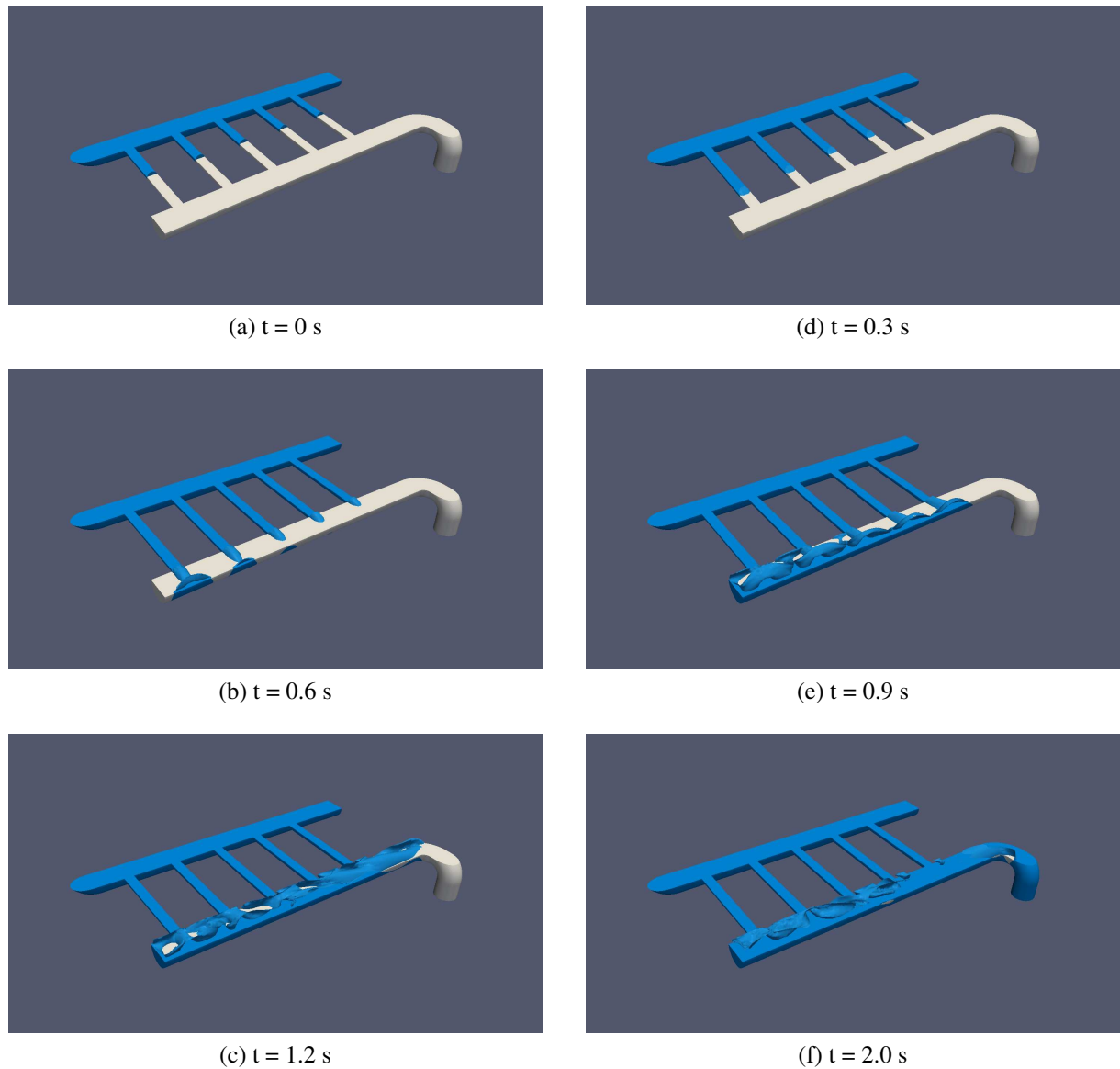
Figura 14: Transitorio inicial de la descarga del tanque a través del arreglo de válvulas, con falla simple en la última válvula (no se modela). El corte horizontal en la geometría permite observar el detalle de la evolución de la superficie libre. El líquido (azul) se encuentra inicialmente en condición estática relleno las cañerías hasta la posición de las válvulas. Al otro lado el gas (blanco) rellena el resto de la red hidráulica.
