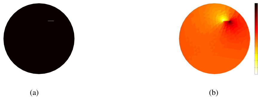
Figura 1: (a) Cuerpo original; (b) derivada topológica. Valor de funcional de costo 3,24 \times 10^{-5} .
