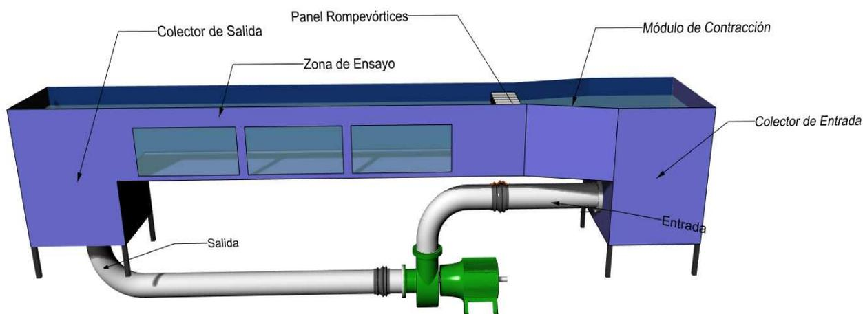
Figura 1: Modelo digital de canal de circulación.
