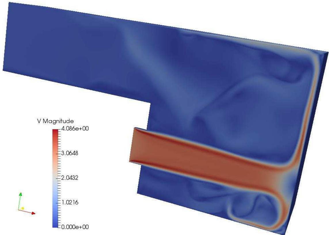
Figura 6: Flujo en el colector de entrada Caso 1.
