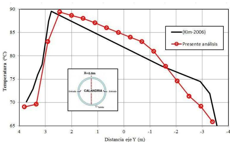
Figura 11: Perfil temperatura en  $x=0$  y  $z=0$  para el Caso 1 de flujo mixto.
