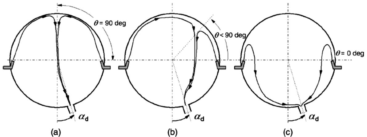
Figura 2: Patrones de flujo identificados dentro del tanque del moderador; a) Flujo dominado por Momento, b) Flujo mixto, y c) Flujo dominado por fuerzas Boyantes (Zadeh, 2017).
