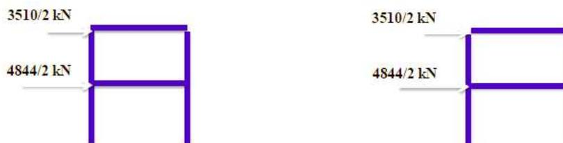
Figura 24: Fuerza lateral equivalente para los elementos del sistema de disipación.
