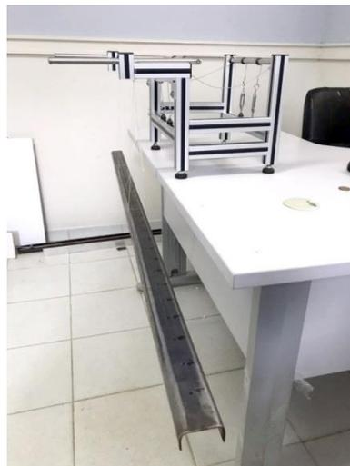
Figura 2: Viga pendurada ao suporte para simular as condições de contorno livre-livre
