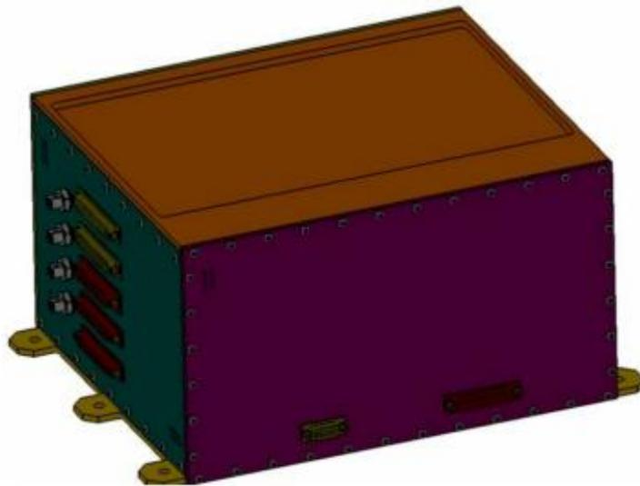
Figura 1: Geometría de la ACE usada como base del modelo FEM
